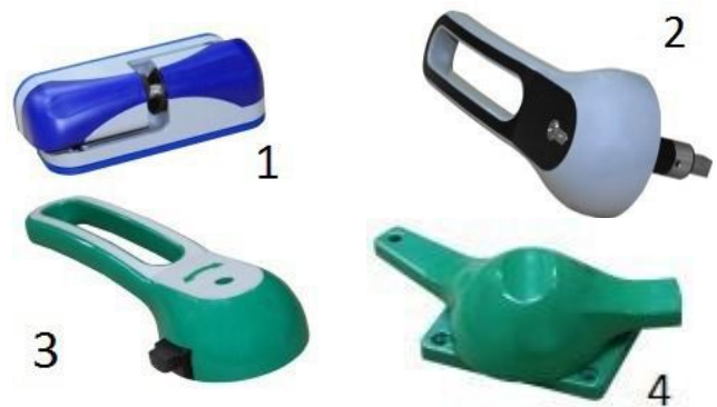
Рисунок 37. Фурнитура РДД серии R (Rahrbach): 1 — дверная металлическая петля с регулировками в трех плоскостях, 2 — наружная поворотная ручка со встроенным замком, 3 — внутренняя поворотная ручка аварийного открывания, 4 — дополнительный затвор для дверей высотой более 2400 мм
