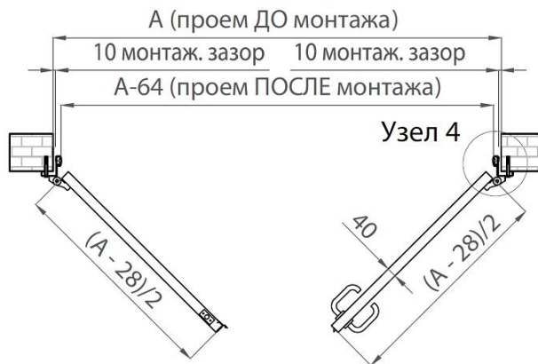
Рисунок 149. Разрез 1-1. Крепление угловой рамы к кирпичной стене
